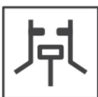
**Versão bifuncional 2" 2F**, também chamada de anti-vácuo, para pontos onde é necessária proteção contra golpe de aríete e não é necessária a expulsão de bolsas de ar durante a operação. É utilizado em bombas, em mudanças de inclinação ascendentes e em longos trechos ascendentes do perfil afetados por fenômenos transitórios.
