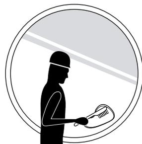
3. As bordas da zona preparada devem ficar perpendiculares à superfície da parede do tubo.
