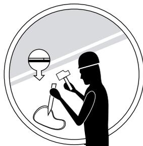
2. Retirar a parte danificada assim como 1,0 a 2,0 cm do revestimento intacto, com a ajuda de uma talhadeira e/ou ponteiro.
